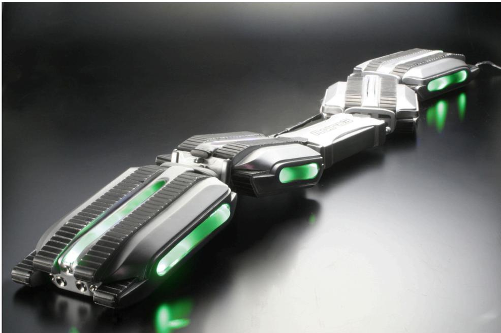
図 1-2 瓦礫内探査用レスキューロボット
